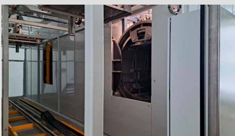
Für die Bauteile wurden Reinigungsgebäude mit den Maßen 1.200 x 800 x 1.000 mm ausgelegt, die automatisiert in die Reinigungskammer gebracht werden.
