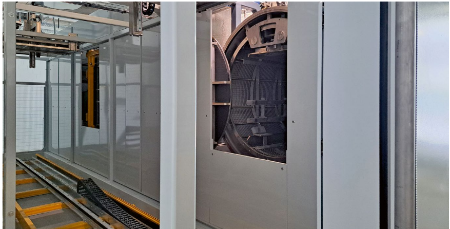
Die Reinigungskammern der neuen Anlage haben ein Fassungsvermögen von je 3700 l Lösemitteln. Nach umfangreichen Reinigungstests und Laboruntersuchungen fiel die Wahl auf einen Kohlenwasserstoff.
