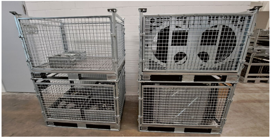
Die Reinigungsgebinde in der Größe von 1200 x 800 x 1000 mm werden automatisiert in die Reinigungskammer eingebracht.
