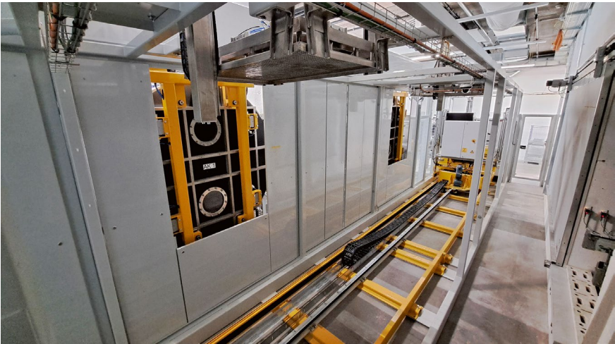
Die neue Zweikammeranlage ersetzt eine alte Durchgangs-Entfettungsanlage und ist Teil einer umfassenden Neugestaltung der Prozesslandschaft sowie des Reinigungsvorgangs mit automatisiertem Bauteiltransfer zwischen Hochregallager und Montage.
